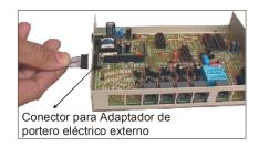
Operación: Cuando Ud. escuche la chicharra del portero proceda de la siguiente manera, descuelgue el microteléfono y disque 5, quedará comunicado con el frente de portero, si ahora desea accionar la cerradura eléctrica disque 8 y ésta será activada durante 5 segundos.
